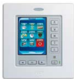
Die Touchpanels zum Wandeinbau lassen sich frei programmieren
